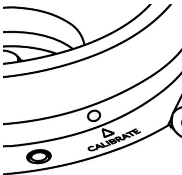
**警告：**研磨粒度指针在校准位置时请勿使用，否则会损坏刀盘。
