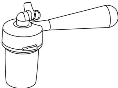
5. 合上透明保护盖(盖子打开时研磨机将无法运行)，并向上轻抬电源开关，以启动电源。
